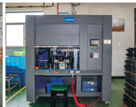
全自动超声波焊接机 Automatic ultrasonic welding machine
